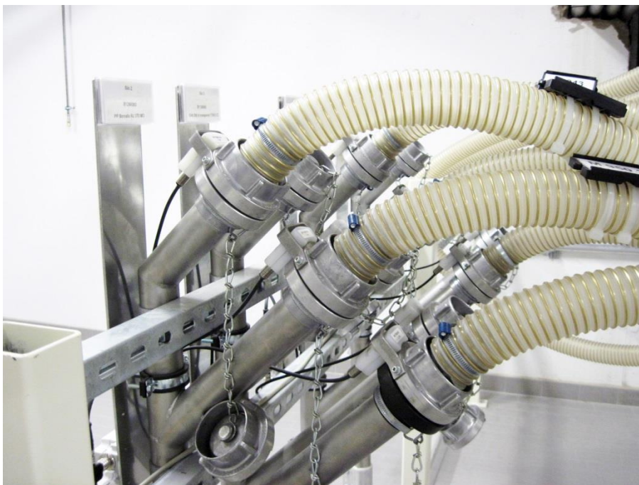
Bild 1. Kupplungserkennung mit RFID
