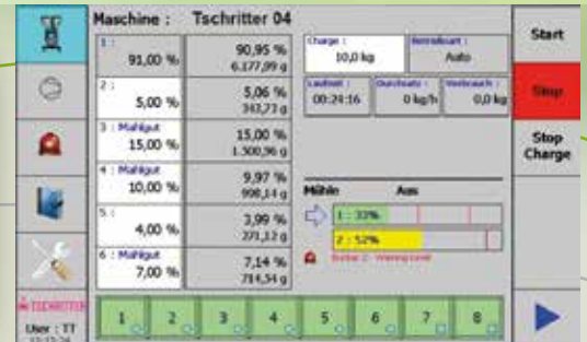
Visualisation : trémie à matériaux rebroyés intégrée
